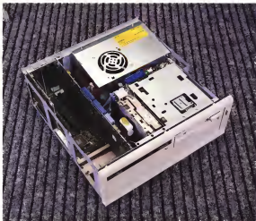
Una delle peculiarità del computer Aperta: libera la disposizione piuttosto piena ed a posizionamento verticale dei circuiti che consente un buon risparmio di spazio.
